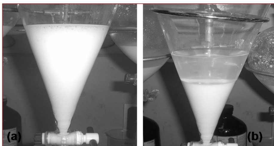
Figura 1: (a) Emulsão estável representativa da água do tratamento térmico e (b) emulsão desestabilizada representativa da água dos tratamentos fotoquímico e/ou químico
