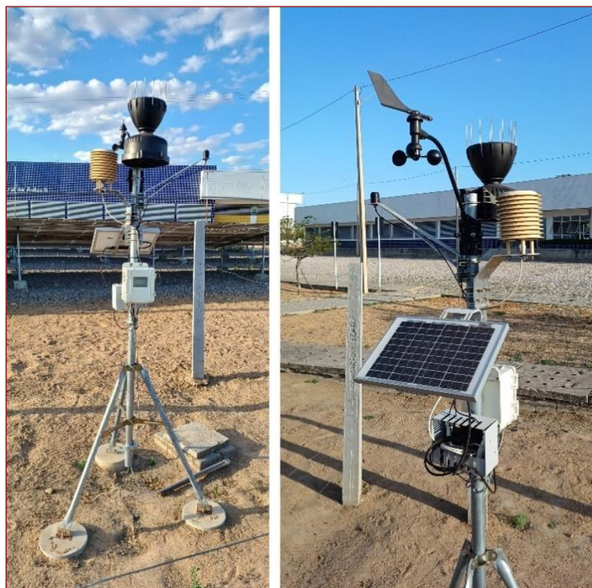
Figura 1 – Estação de monitoramento remoto HOB0 RX Station – RX3000, localizada na UFERSA – Campus Caraúbas
