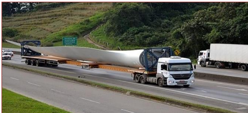
Figura 1- Transporte de Turbina Eólica
