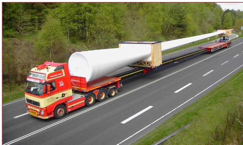
Foto 6 – Pá Eólica coberta por lona sendo transportada.
